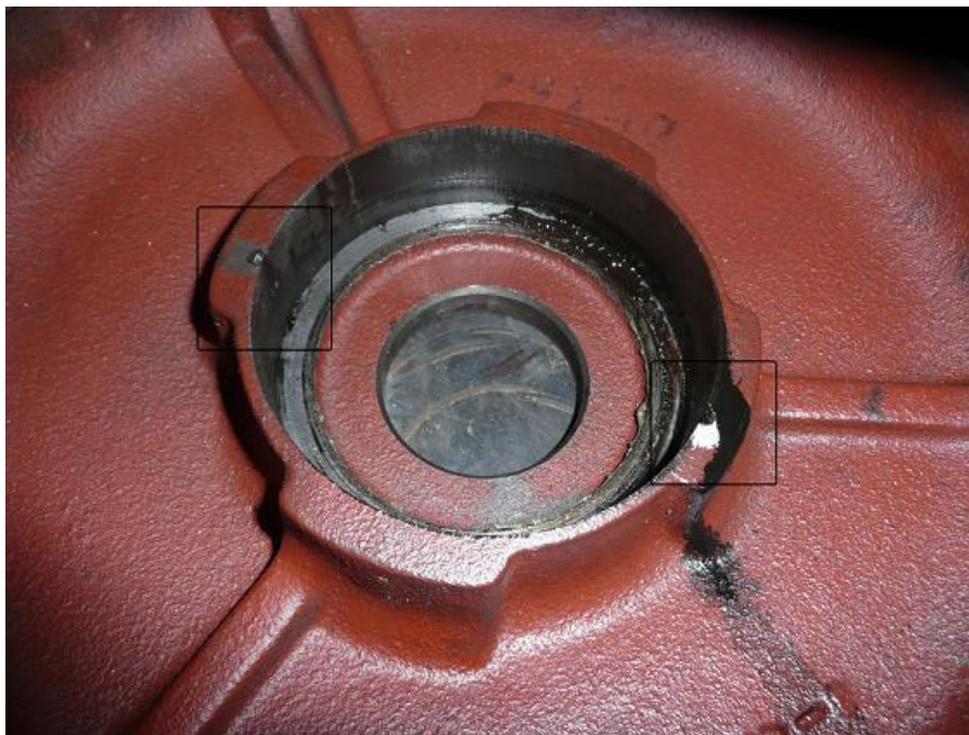
Obr.5 víko ložiska s viditelnými zápusnými červíky k vymezení vůlí vložky ložiska
