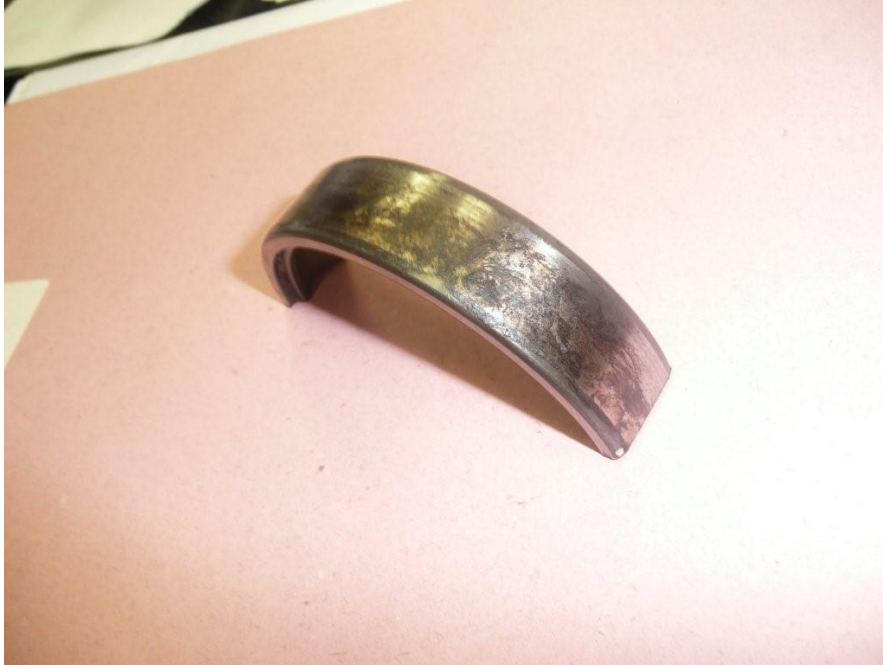
Obr.4 viditelná styková koroze na povrchu ložiska
