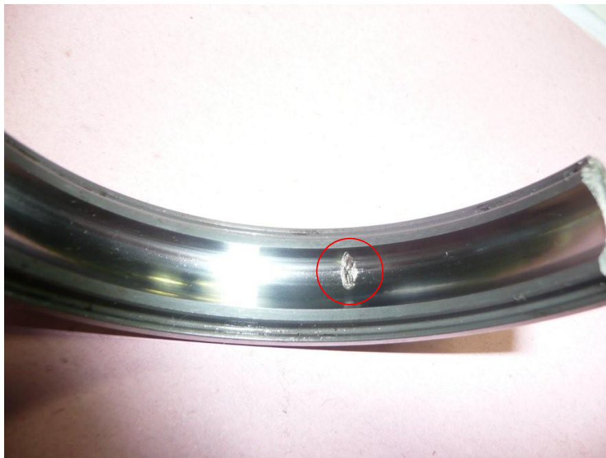
Obr.5 vnější kroužek ložiska s patrným pittingem na valivé dráze
