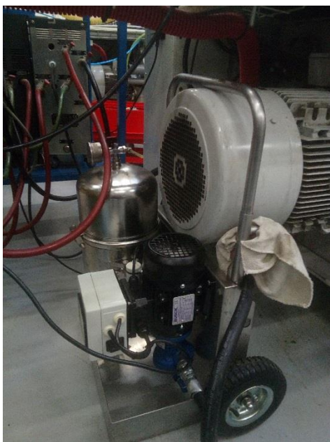
Mobilní filtrační jednotka EF V2115 zapojená na nádrži vstřikolisu
