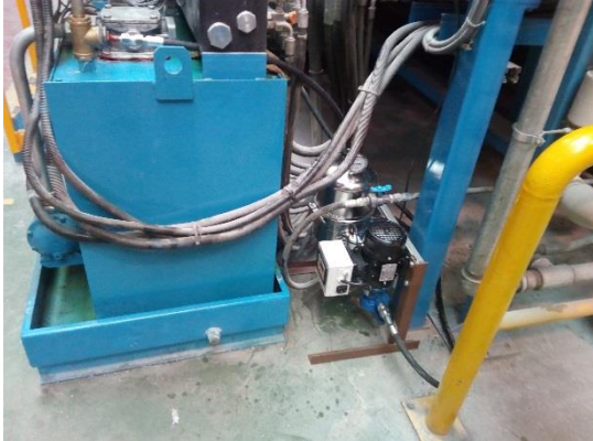
Zapojení filtrační jednotky na hydraulické nádrži-offline zapojení
