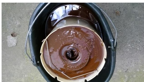
Z Zanesený filtr po filtraci. Je zde patrný výskyt měkkých kalů. Filtr je schopen absorbovat až 1755 g nečistot.
