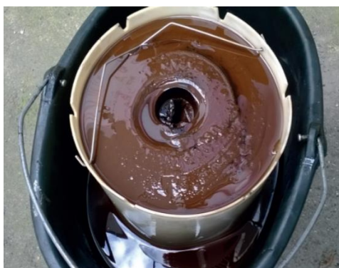
Obr. Vyčištěný systém centrálního mazání od měkkých kalů (kód čistoty byl 6)
