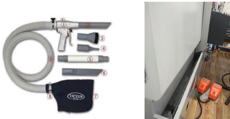
Obr. Ofukovací a sací pistole vhodné zejména pro obráběcí stroje např. špony ve dveřích
