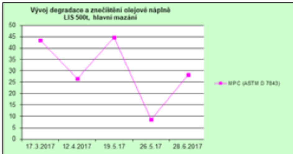
Obrázek 4: Graf průběhu stanovení MPC v rámci filtrace i běžného provozu lisu
