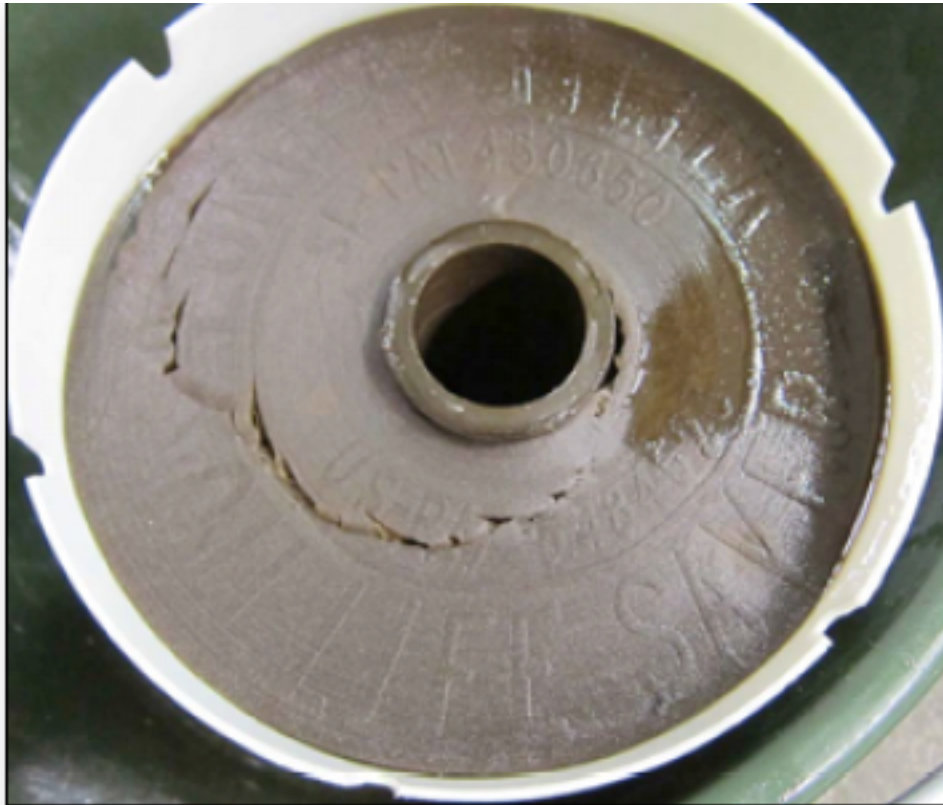
Obrázek 3: Zanesený filtr po filtraci. Je zde patrný výskyt měkkých kalů
