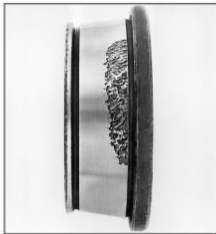
40: Nakloněná kolej na kuželíkovém ložisku
