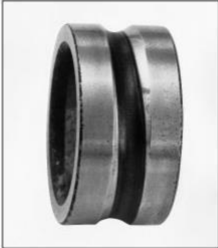
39: Šikmá dráha ve vnitřním kroužku kuličkového ložiska s hlubokou drážkou
