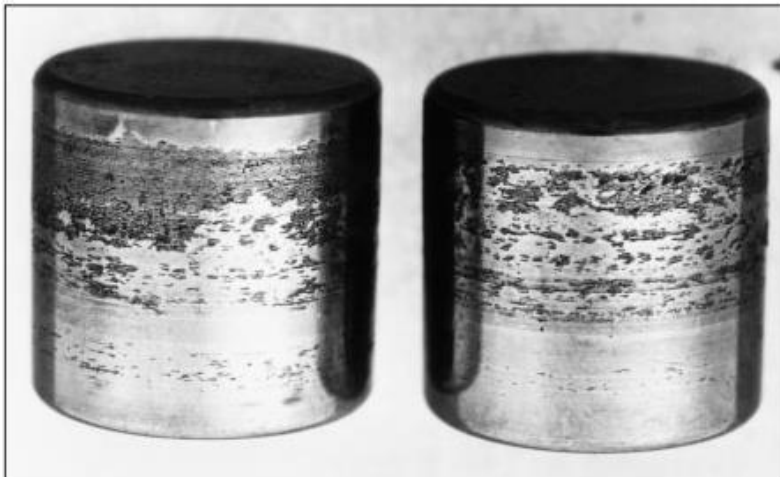
74: Kluzné dráhy na válcových válcích
