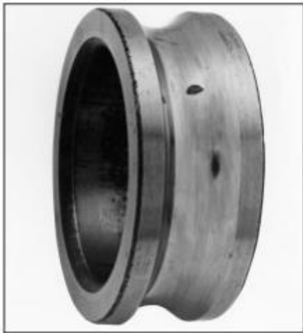
41: Klasická únava může být rozpoznána prohloubením vnitřního kroužku kuličkového ložiska s hlubokou drážkou do dráhy. Při postupném poškození se materiál odlupuje z celé dráhy.
