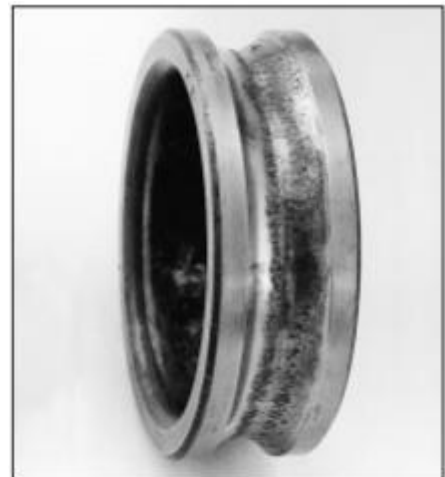
42: Pokročilé únavové poškození kuličkových ložisek s hlubokými drážkami.
