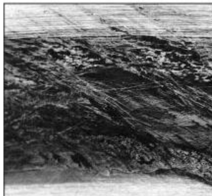
82: Při nedostatečném zásobování mazivem a vysokém zatížení může na tváři a rtu válce dojít k zadření.
